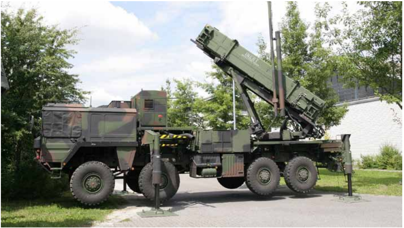
Patriot-Startgerät mit PAC-3 Lenkflugkörper und leeren PAC-3 Startbehältern. Foto: Bundeswehr/Gygas über flickr „Wir dienen Deutschland“
