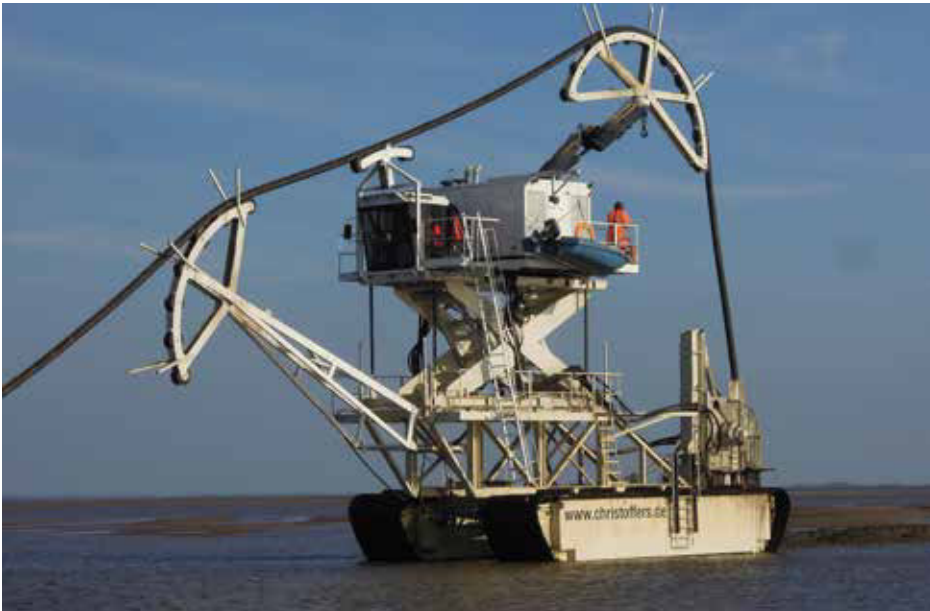
Verlegungsschiff für Transatlantikkabel „Nessie II“. Quelle: Fritflash/Wikipedia
