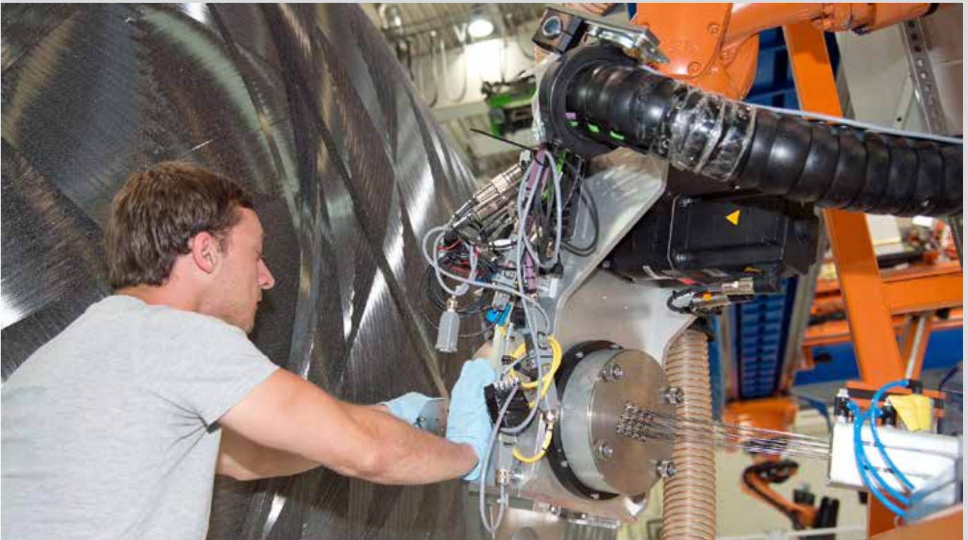
Das beim DLR Stuttgart und Augsburg in Kooperation mit MT Aerospace entwickelte und gefertigte Boostergehäuse. Quelle: DLR (CC-BY 3.0)
