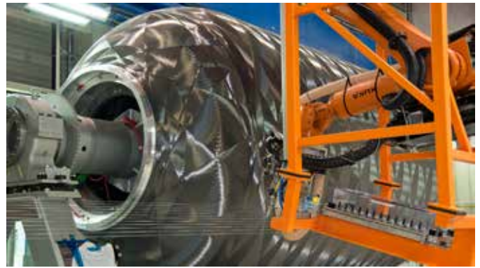
Das Boostergehäuse aus Carbonfasern für die Ariane 6 wurde beim DLR Stuttgart und Augsburg in Kooperation mit MT Aerospace entwickelt und gefertigt. Foto: 2015-07-01.
