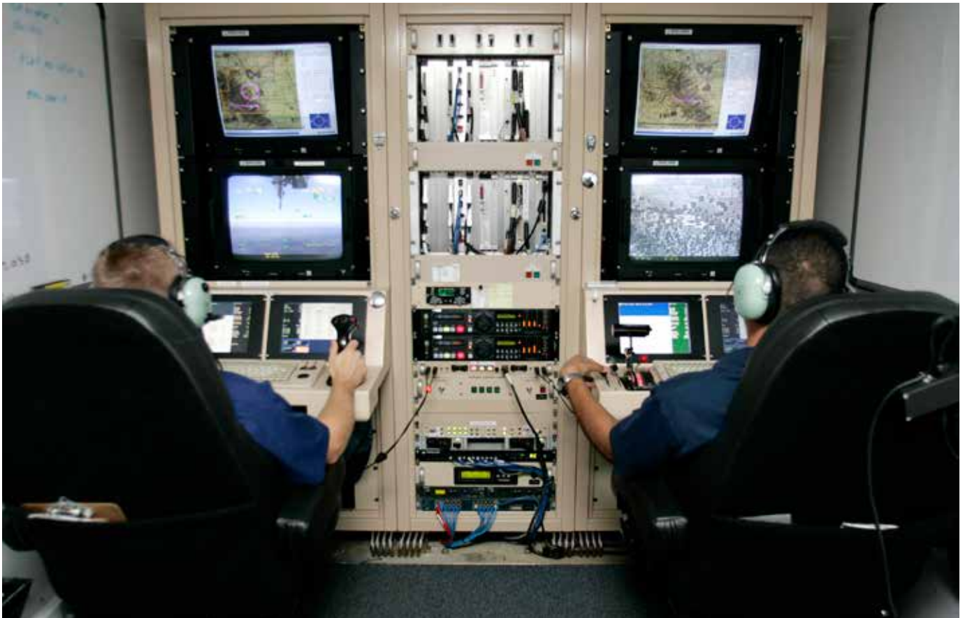
Boden-Kontrollstation für Drohnen-Einsätze. Quelle: Gerald Nino/Wikipedia
