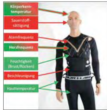
Abb. 2: Beispiel einer smarten Textilie mit Sensortechnik zur Erfassung relevanter Vitalparameter (Quelle: WIWeB)
