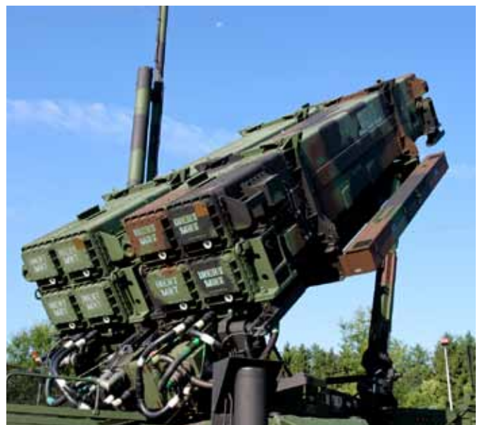
PATRIOT-Startgerät mit PAC-3 Lenkflugkörper mit leeren PAC-3 Startbehältern. Foto: Bundeswehr/Gygas über Flickr: Wir.Dienen. Deutschland.
