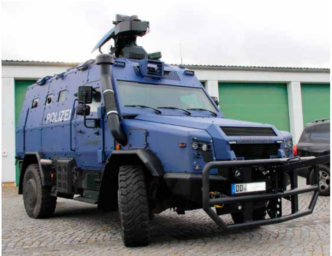
Der neue Polizeipanzer „Survivor R“ der sächsischen Polizei. Das Fahrzeug verfügt über einen Gefechtsturm mit Abschussvorrichtung. Quelle: Rheinmetall Defence via Wikipedia (CC BY-SA 4.0).
